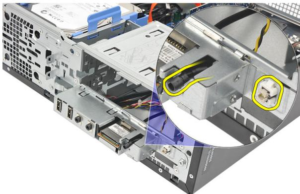
6. Deslize o cabo de LED do disco rígido e da chave liga/desliga através da frente do computador.
