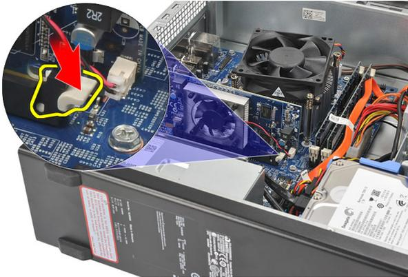
5. Levante a placa de expansão e a puxe para fora de conector e retire-a do computador.
