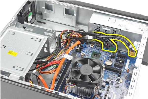
4. Resenrosque os cabos dos grampos metálicos.
