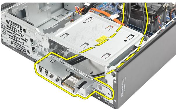
9. Libere os grampos de retenção usando uma chave de fendas pequena e com cabeça plana, e libere o leitor de cartões SD.
