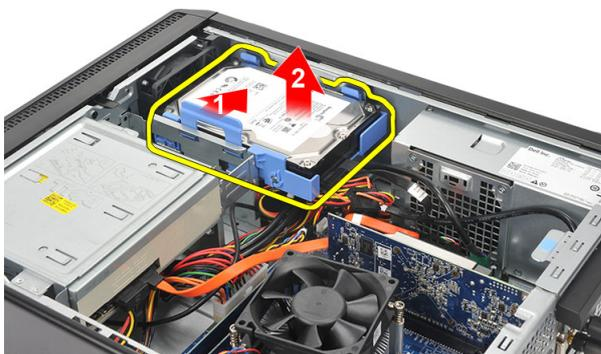
4. Desconecte o cabo de dados e o cabo de alimentação do disco rígido.
