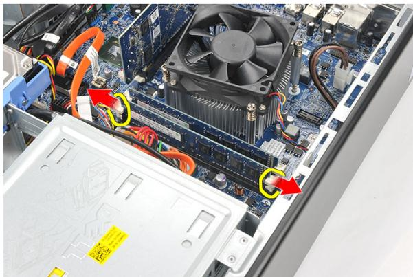
4. Levante o módulo de memória co conector na placa de sistema.
