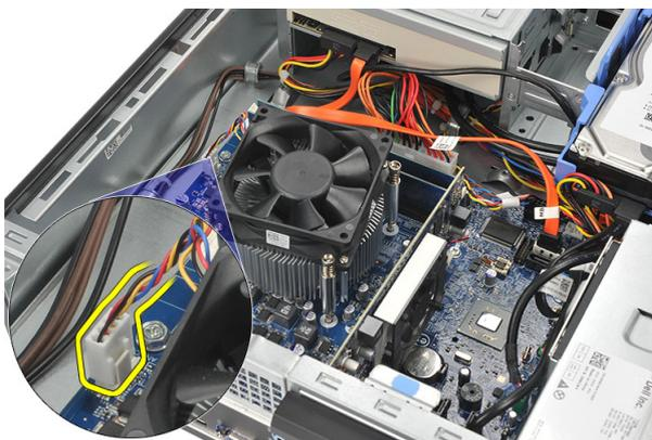
4. Solte os parafusos prisioneiros que prendem o conjunto dissipador de calor e ventilador na placa de sistema.
