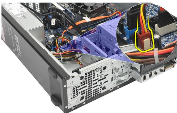
4. Remova os parafusos que seguram o ventilador ao computador.
