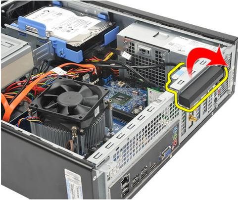
5. Segure a placa pelos cantos superiores e solte-a do conector.
