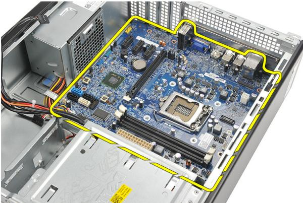
12. Retire a placa de sistema do computador e coloque-a em uma embalagem anti-estática.
