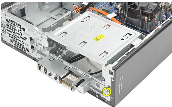
8. Deslize o painel de E/S na direção do fundo computador e remova o painel de E/S do computador.
