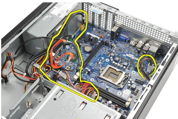
10. Remova os parafusos que fixam a placa do sistema ao computador.
