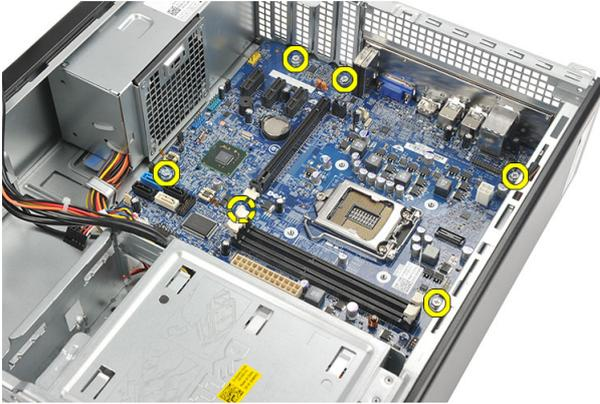
11. Deslize a placa de sistema na direção da frente do computador e incline cuidadosamente até um ângulo de 45 graus.
