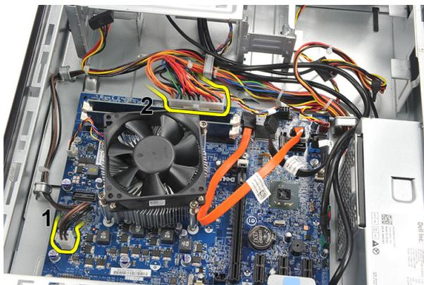
7. Resenrosque os cabos de alimentação dos grampos metálicos.
