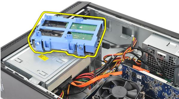
6. Empurre as duas presilhas, afastando-as do disco rígido e remova o disco rígido de seu respectivo suporte.
