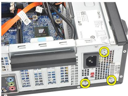
9. Pressione a aba de liberação azul ao lado da fonte de alimentação e deslize a fonte de alimentação em direção à frente do computador.
